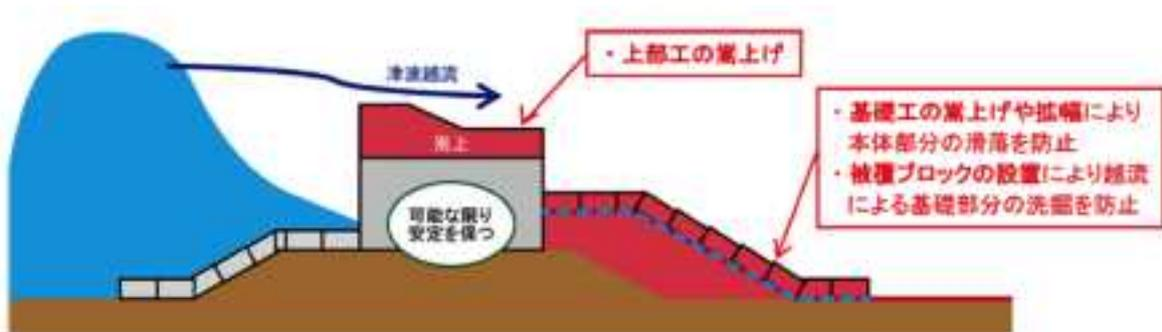
ねばり強い構造とすることで被害を押しえるための堤防強化について
