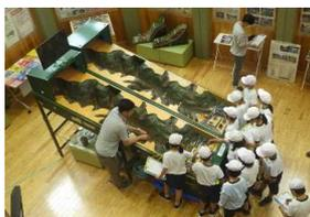
土石流模型装置による実験
