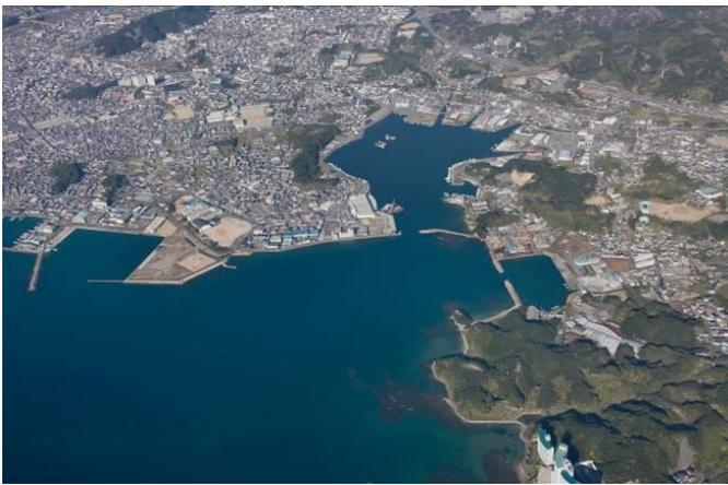
文里港の背後地には、県立神島高等学校や田辺港湾合同庁舎が立地し、人家なども密集しています。しかしながら、護岸高が不足していることから、台風などの際には、高潮による浸水被害が発生していたため、平成21年度から護岸の嵩上げや消波工、また令和2年度から、排水ポンプ場の老朽化に伴う修繕などの工事を実施しています。
