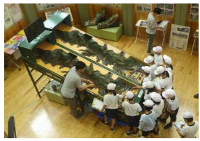
土石流模型装置による実験
