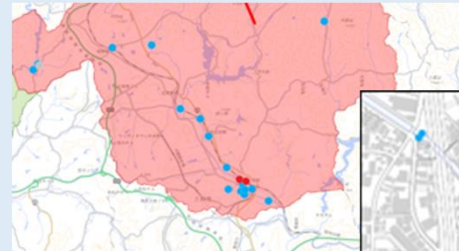
浸水センサ表示システムのイメージ（広域&拡大）
