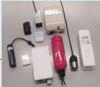
実証実験に用いている浸水センサ
