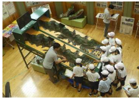
土石流模型装置による実験
