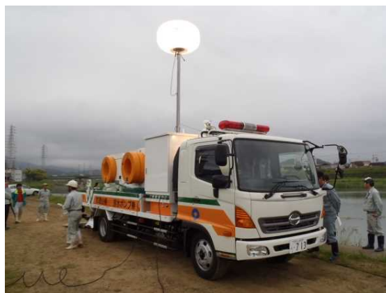
排水ポンプ車
