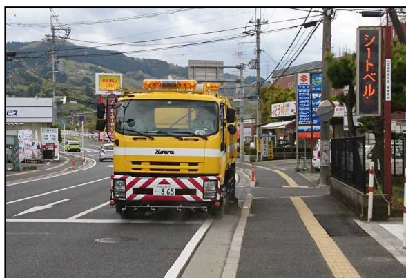
【路面清掃車を用いた道路清掃】
