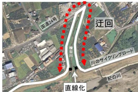
図12 サイクリングロードの直線化
