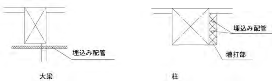
図8-4-1 電気等の埋込み配管要領
