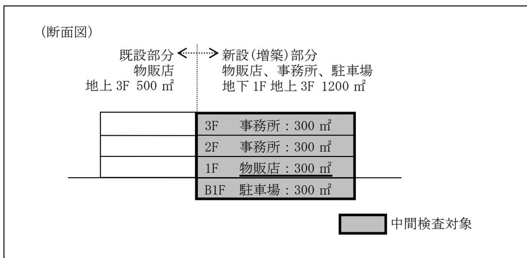
5. 1棟を2以上の工区に分けて施工し、特定工程に到達する時期が異なる場合は、最も早く特定工程に到達する工区について中間検査が実施されます。なお、対象建築物が複数ある場合は、各棟について最も早く特定工程に到達する工区においてそれぞれ実施されます。
