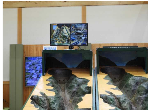
土石流発生模型装置を用いた砂防えん堤の 効果実験動画
