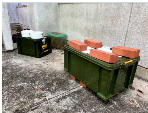
高感度な地震計を用いた地盤振動の計測状況
