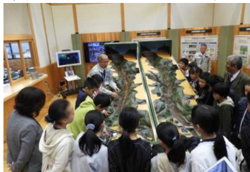
写真-4 土石流発生装置による砂防堰堤の効果に関する実験の様子
