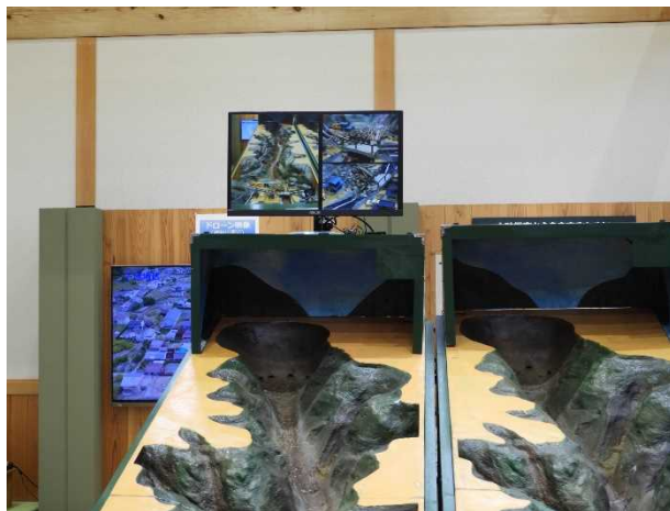
土石流発生模型装置を用いた砂防えん堤の 効果実験動画
