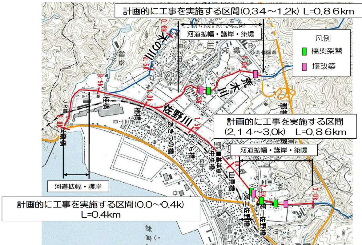
図 4.2 河川改修概要図
