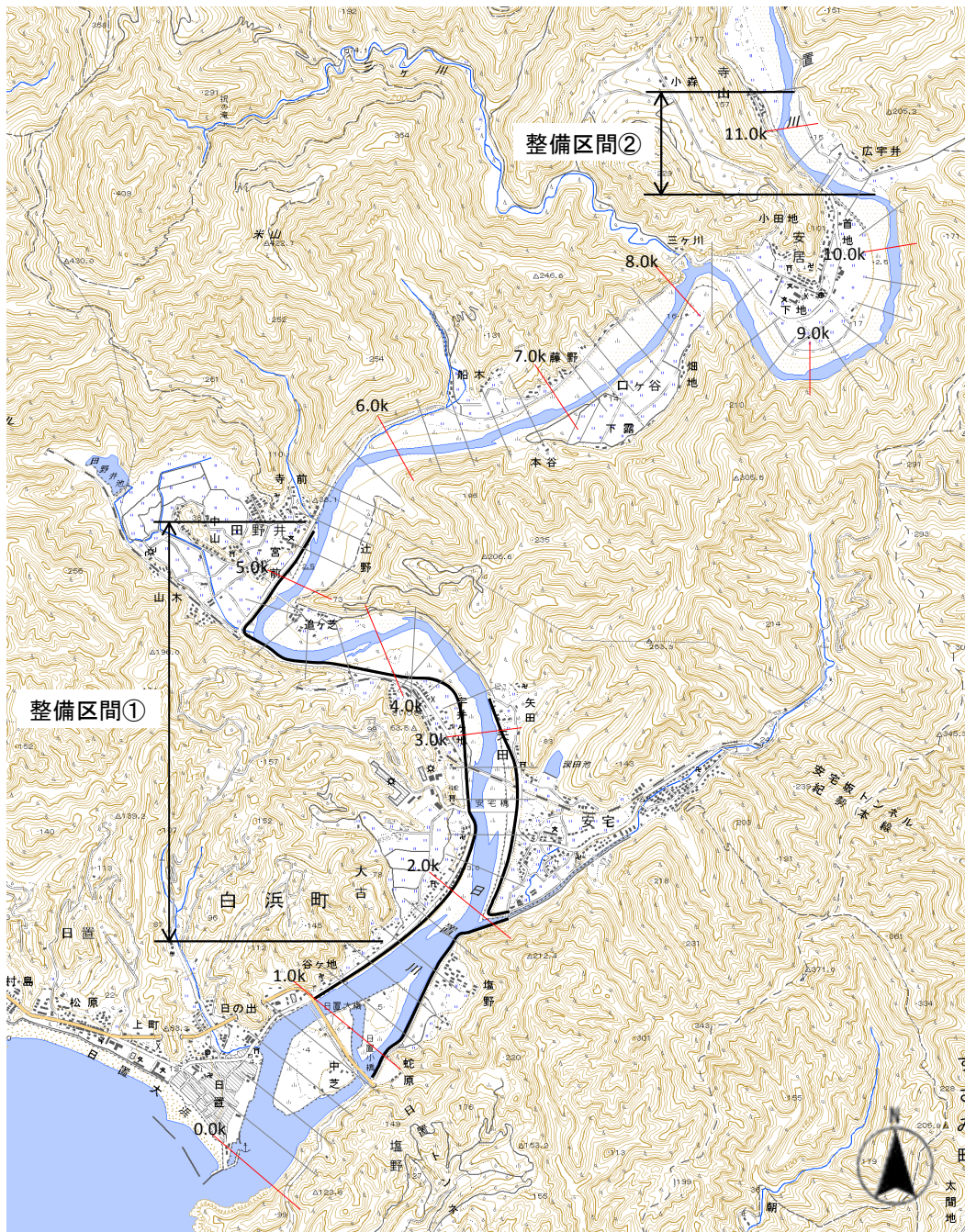
図 1 3 計画的に河川工事を実施する区間
