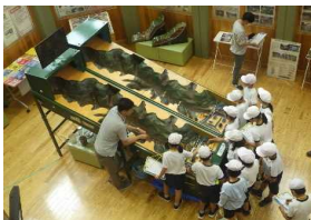
土石流模型装置による実験
