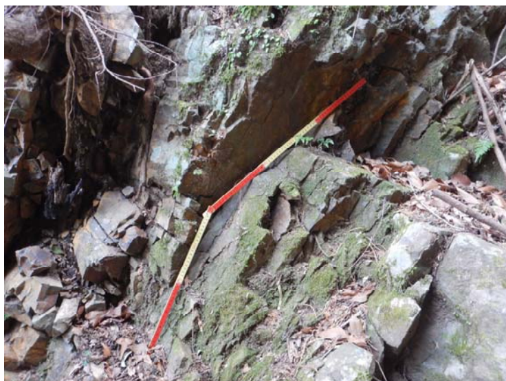
写真 3.2.6 玢岩岩脈と泥岩の境界 折尺が境界で手前側が泥岩、奥が玢岩
