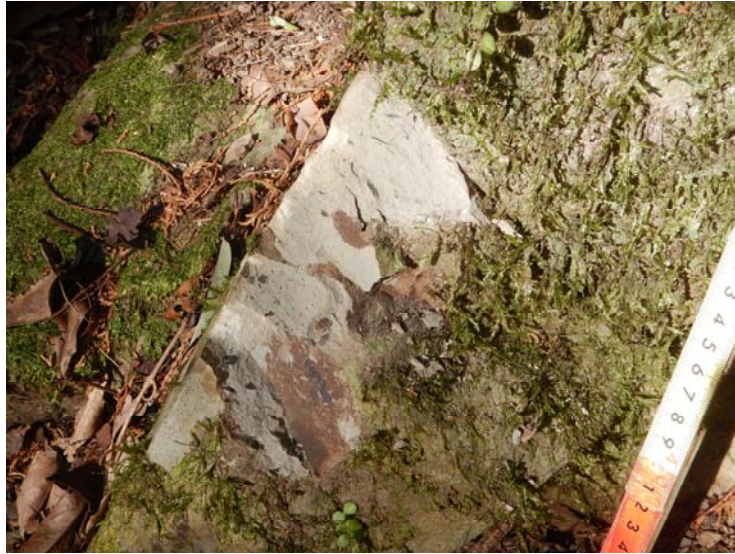
写真 3.2.3 泥岩に挟在する厚い細粒砂岩 この付近では細粒砂岩は層厚 5～100cm
