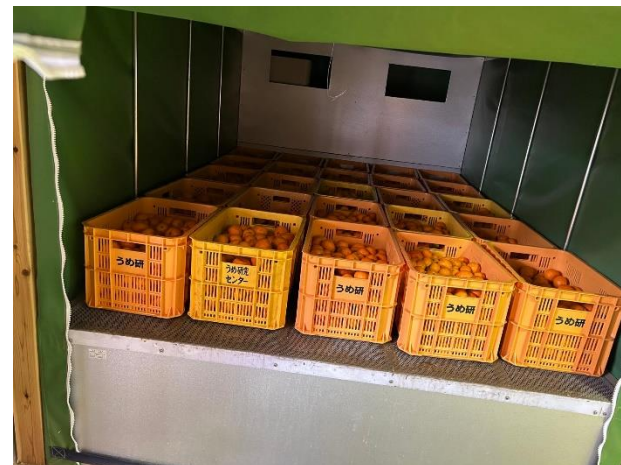
除湿式乾燥機による乾燥の様子（処理前）
