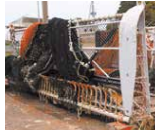
左/ まんが漁で使う漁具。熊手のような爪を備え、両脇の板でスキーのように海底を滑らせる。右/30分ほど海底をかき、網を引き上げる。これを一度の漁で10数回行う。
