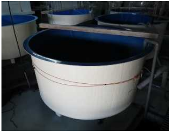
1 トン FRP 水槽
