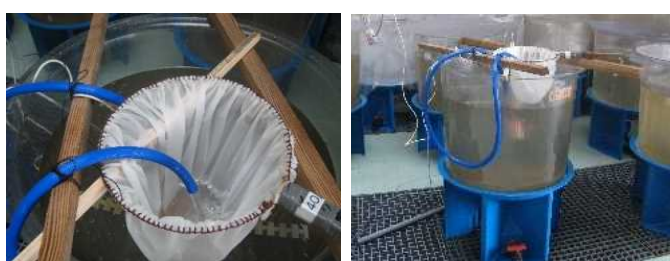
吸い上げた海水を 40 μm メッシュネットでろ過して水槽内へ戻す
