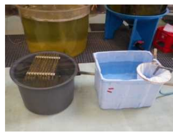
波板セットが入る水槽 2 基 (水道水・ろ過海水)
