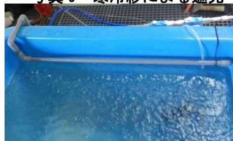
写真10 送風装置の設置
