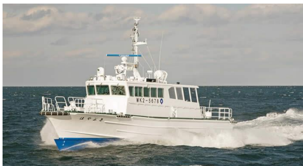
漁業取締船「はやぶさ」平成28年12月竣工 総トン数38トン 最大速力36.0ノット
