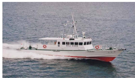
漁業取締船「みさき」平成14年7月竣工 総トン数39トン 最大速力45.8ノット
