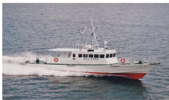
漁業取締船「みさき」平成14年7月竣工 総トン数39トン 最大速力45.8ノット
