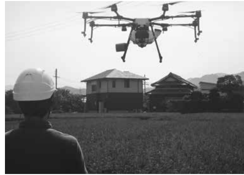
図3 農業用ドローンによる農薬散布
