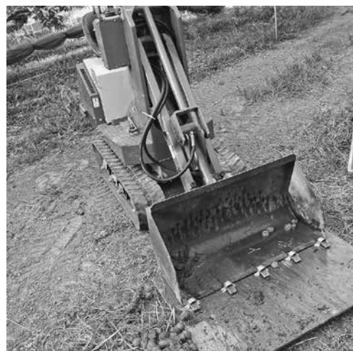
収穫ネットごとすくい上げてバケットに入れる実験機 1 号
