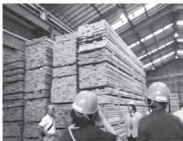
製材・集成材の製造 (集成の製造では、加工時に材 料の約20%のくずが発生する)
