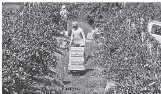
スマート農機の現地実証（上富田町 左：リモコン式自走運搬車、右：リモコン式自走草刈機）
