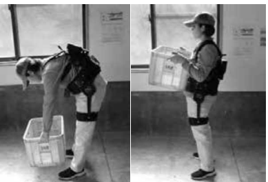
④パワーアシストスーツ(パワーアシストインターナショナル(株))
