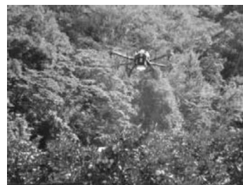
⑤農薬散布用ドローン(XAIRCRAFT JAPAN(株))
