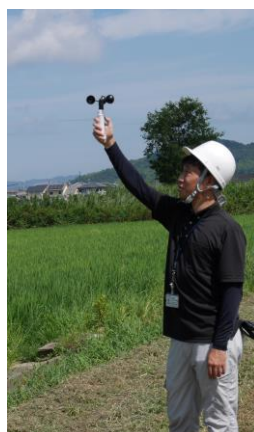
左：散布時の風速測定
