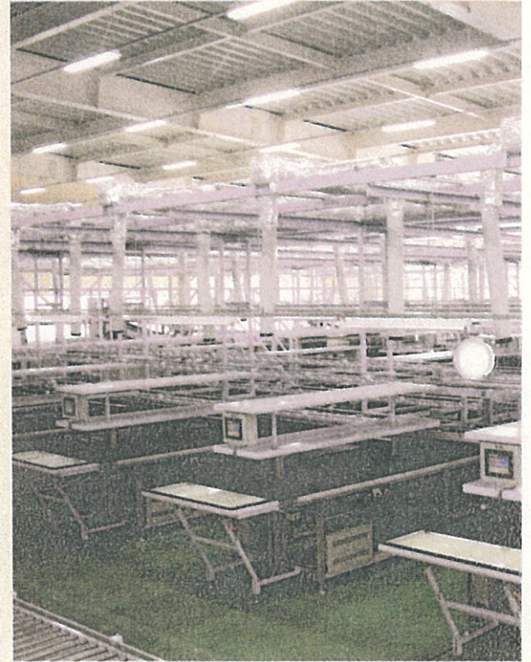
●桃柿併用選果機(イタマーズ5号) 光センサー、カラーセンサー、 トレーサビリティ装置付き
