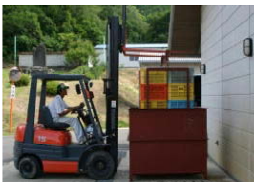
図3 大型水槽による大量浸漬処理
