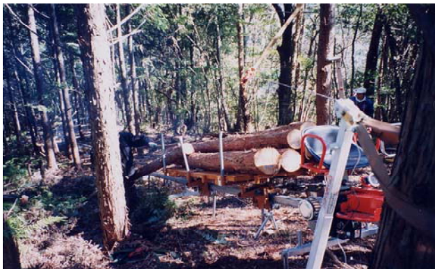
写真1 モノレール台車への積み込み状況
