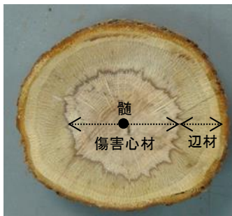
図 1 被害原木の木口断面 (中心部に傷害心材が形成)
