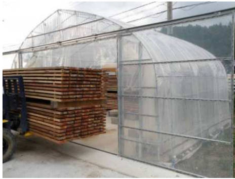
図 1 太陽熱利用木材乾燥施設
