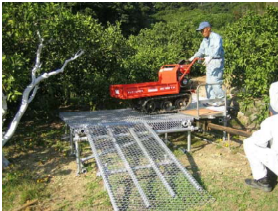
図2 テラスへのクローラ運搬車の乗降
