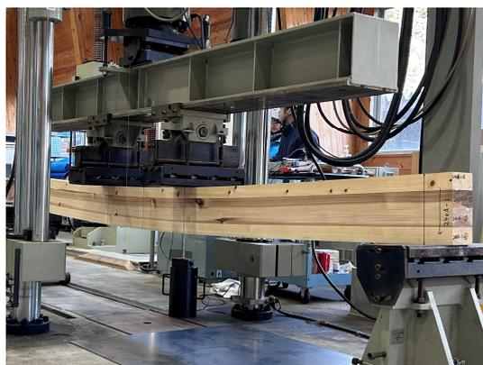
図 5 曲げ強度試験
