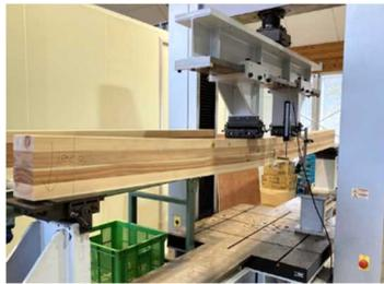
図4 曲げ強度試験
