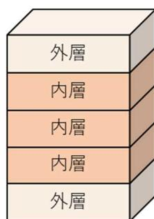
図1 接着重ね梁のイメージ図
