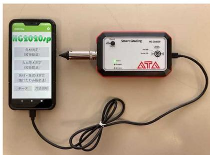
図 1 簡易型強度測定器
