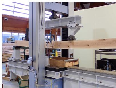
図 4 曲げ強度試験
