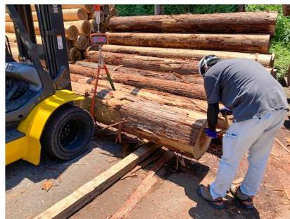
図 2 重量及び固有振動周波数測定
