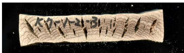
図2 内部割れ, 変形の状況
