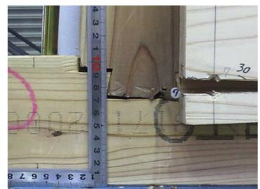
柱脚部付近での面材の割裂
