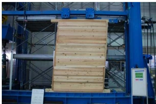
図 2 面内せん断試験の実施状況
