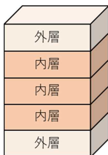
図1 接着重ね梁のイメージ図
