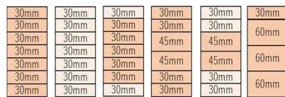
図3 作製した22パターンの接着重ね梁イメージ図
