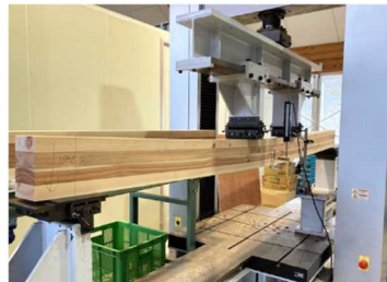
図4 曲げ強度試験
