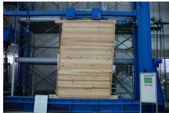
図 2 面内せん断試験の実施状況 (試験体寸法、1,820 × 2,730mm)
