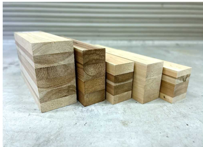
作製した接着重ね梁の一例
