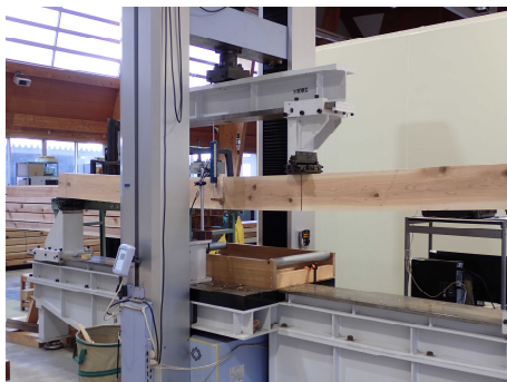
図 2 曲げ強度試験の様子
