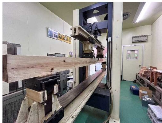
曲げ強度試験（注：写真はスギで実施したもの）
