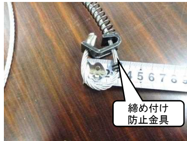
輪の直径の確認と締め付け防止金具の有無
