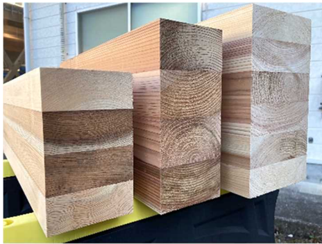
図2 作製した接着重ね梁の一例
